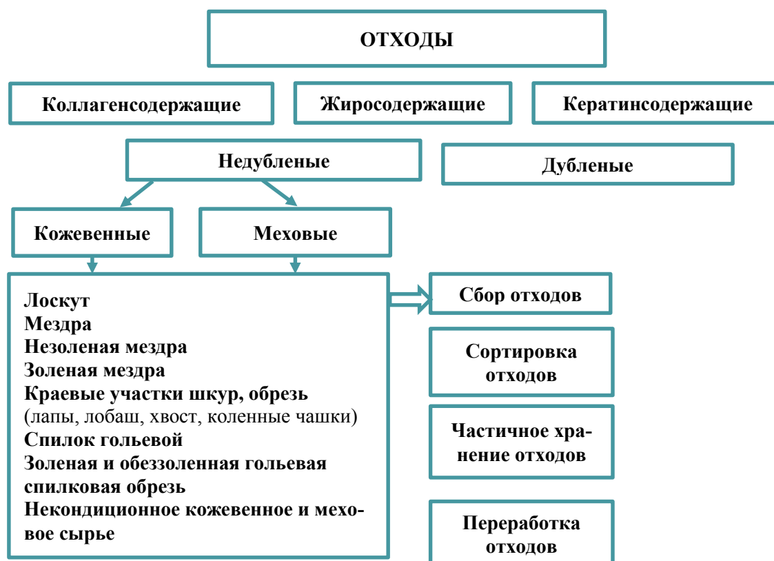
Рис. 1. Технологическая схема переработки коллагенсодержащих отходов
