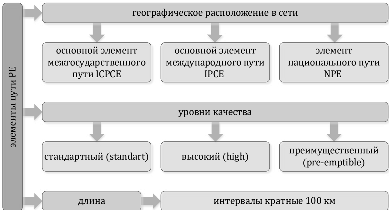
Рис. 1. Классификационные признаки элементов пути PE
