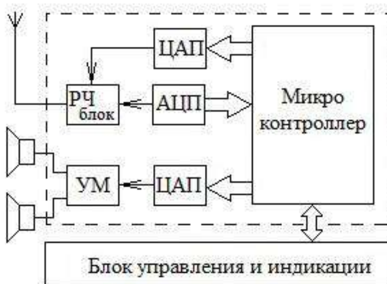
Рис. 2. Обобщенная структурная схема SDR-радиоприемника
