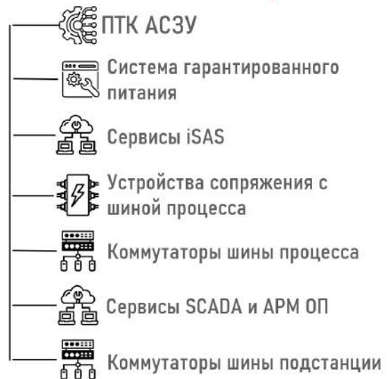
Рис. 5. Перечень функций, реализуемых в ПТК АСЗУ
