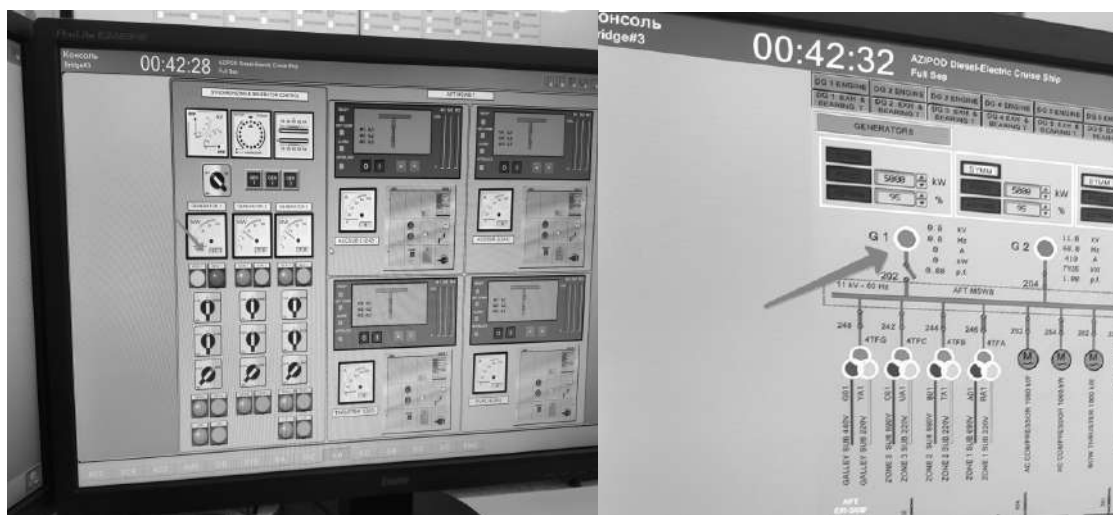
Рис. 3. Пример отображения данных по мощности при отключенном от шин генераторе
