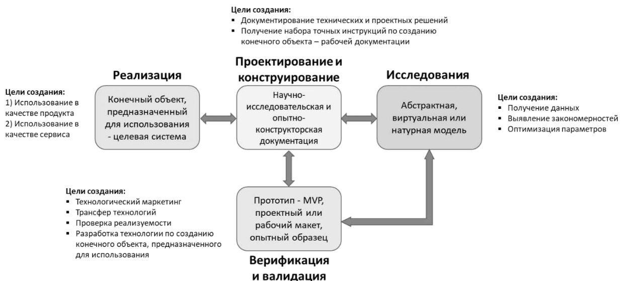
Рис. 1. Обобщенная схема жизненного цикла дизайна проекта
