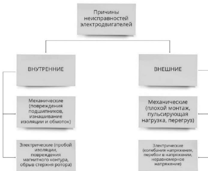
Рис. 2. Причины неисправностей электродвигателей
