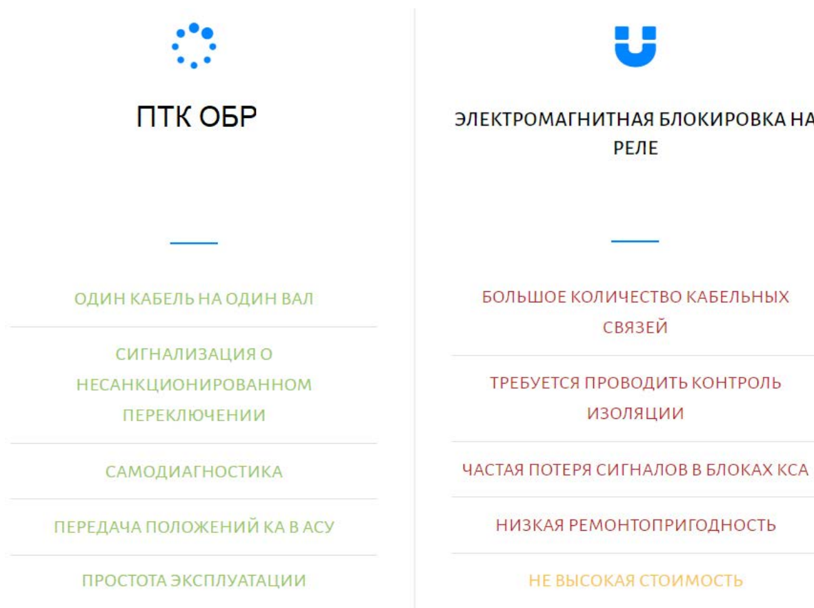
Рисунок 3. Сравнение предлагаемой и традиционной видов блокировок
