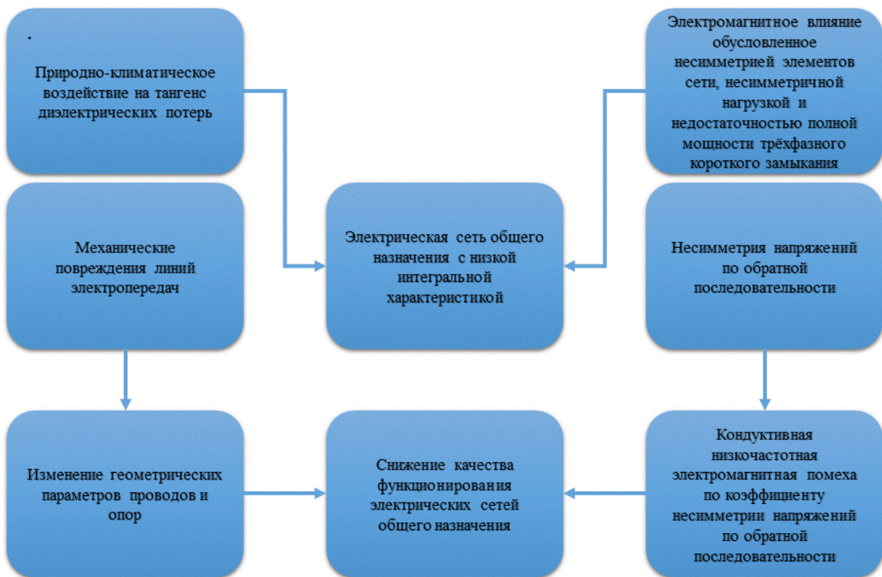
Рисунок 1. Схема взаимодействия влияния факторов на качество функционирования исследуемой электрической сети
