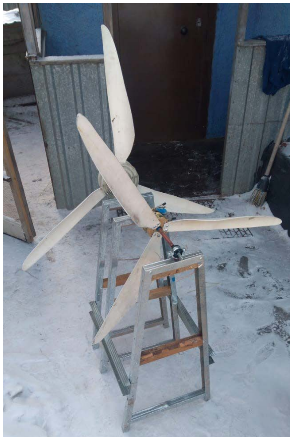
Рисунок 3. Физическая модель взаимодействия ветрового потока с ветротурбинами
