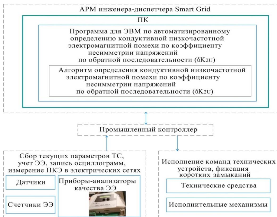
Рисунок 1. Структурная схема взаимодействия средств автоматизированного определения и подавления \delta K_{2U}
