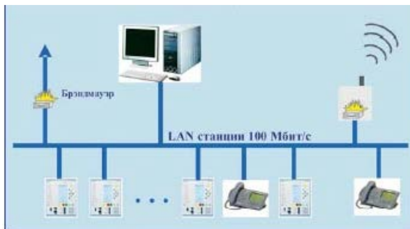
Рисунок 3. Единая сеть TCP/IP на базе МЭК 61850
