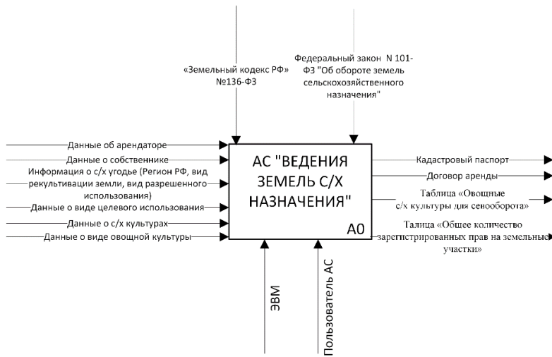
Рис. 1. Контекстная диаграмма функциональной модели АС
