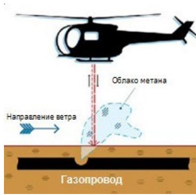
Рис. 3. Контроль утечек метана с воздуха
