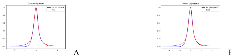
Рис.4. Аппроксимация (А) и интерполяция (Б) функции f(x) = \frac{1}{1+25x^2} с разбиением на 500 точек, в интервале от -2.5 до 2.5 нейронной сетью с 1 нейроном на входном слое, 3 нейронами на скрытом слое и 1 нейроном на выходном слое обученной на 25 эпохах.
