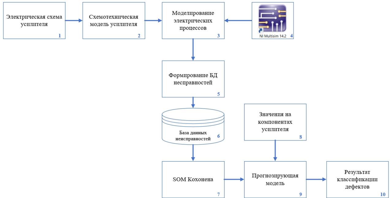
Рис. 2. Структурная схема процесса диагностики схемы усилителя
