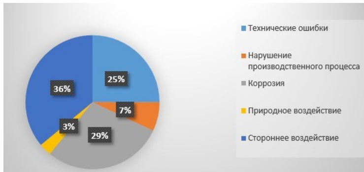
Рис. 1. Диаграмма распределения причин утечек на газопроводах
