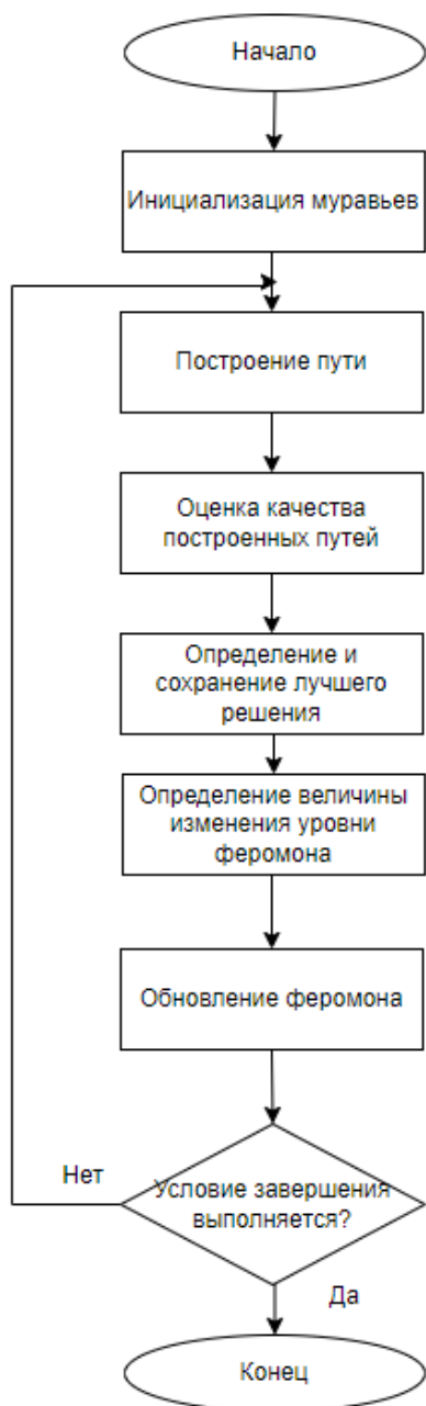
Рис. 3. Структурная схема муравьиного алгоритма
